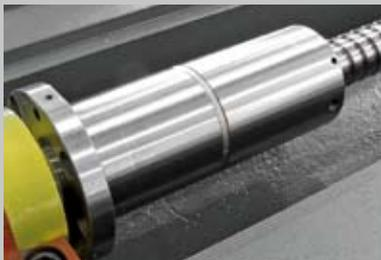
**Kugellrollspindel mit 2-fach Mutter**
