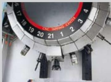
**plus** In 1,4 Sekunden Werkzeugwechsel
